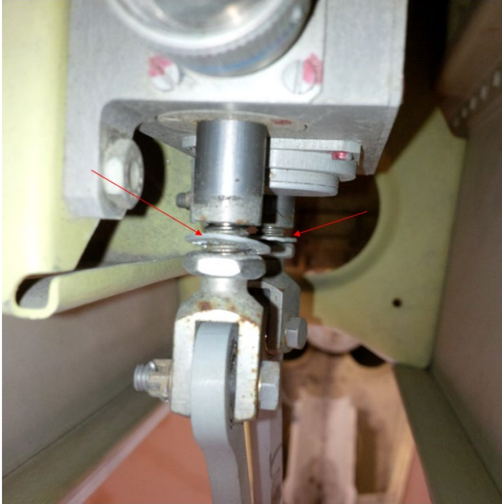
Rudder trim actuator loose jam nuts
